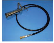
■スノーホーン (雪状ドライアイス簡易発生装置) 液化炭酸ガスを急激に放出することでスノー ドライアイスを効率よく大量に作ります。
