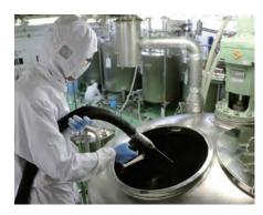
■ドライアイスブラスト (ドライアイス洗浄システム) 対象物にキズを付けず高い洗浄能力を発揮。 作業後は不燃性の気体になり清掃不要です。
