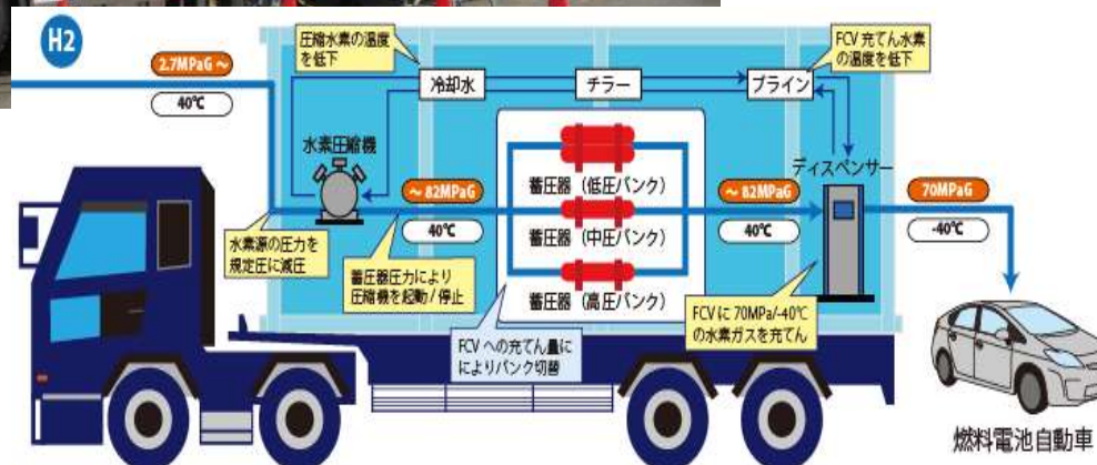
水素ステーション内部詳細
